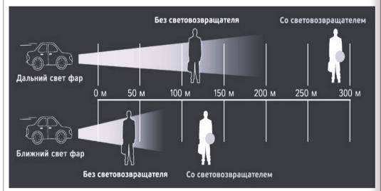
При движении с ближним светом фар водитель автомобиля способен увидеть пешехода на дороге на расстоянии 25-50 метров. Если пешеход применяет световозвращатель, то это расстояние увеличивается до 150-200 метров. А при движении автомобиля с дальним светом фар дистанция, на которой пешеход становится виден, с применением световозвращателей увеличивается со 100 метров до 350 метров. Это даёт водителю 15-25 секунд для принятия решения.
